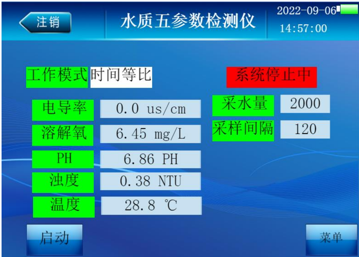
该画面中，显示采样模式、采样量、采样间隔时间、以及水质五参数数值
